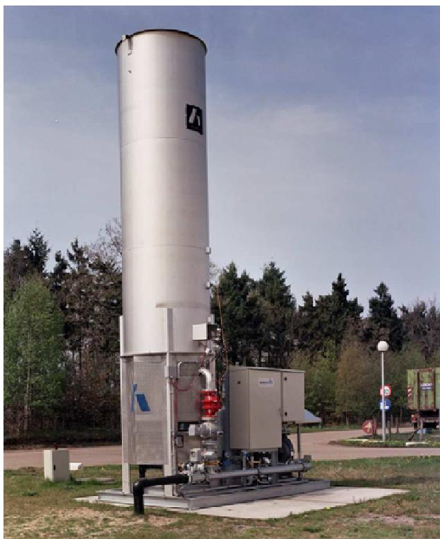
Рисунок 7 – Газосжигательная установка.
