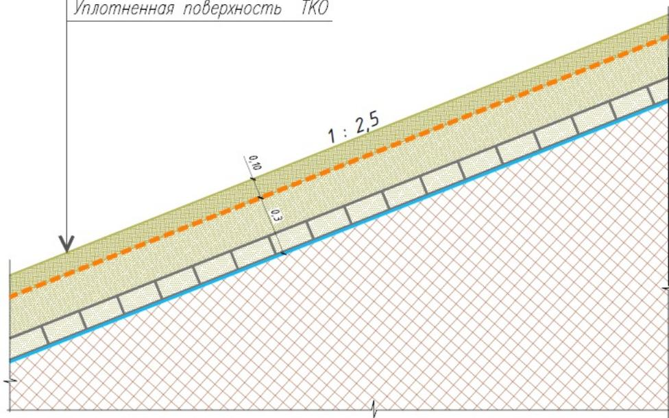
Рис. 14. Защитный экран склонов поверхности полигона толщиной 0,4м
