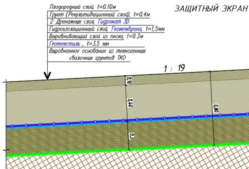
Рис. 8. Противофильтрационный экран с применением геосинтетических материалов, общей толщиной 0,8м
