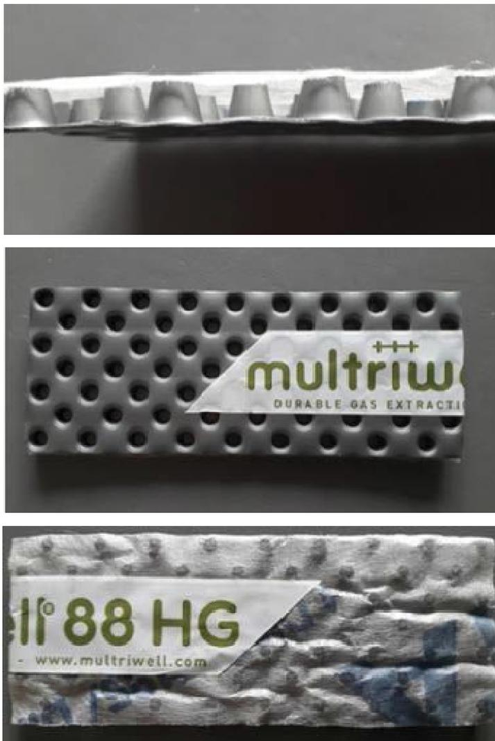
Рисунок 6 – Геосинтетическая ткань Multriwell H-тип
